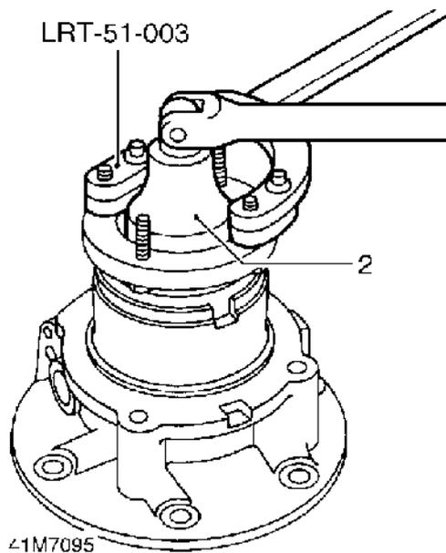
1. Positionner l'outil de maintien de flasque d'arbre de transmission LRT-51-003 sur le flasque d'arbre de sortie.
