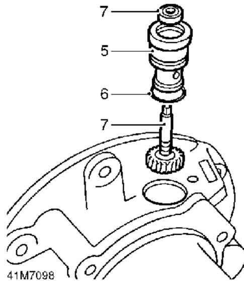
5. A l'aide d'un levier, extraire prudemment le pignon d'indicateur de vitesse et le boîtier hors du boîtier de sortie arrière.
