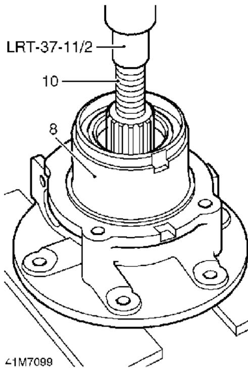
8. Placer le boîtier de sortie arrière sur le banc d'une presse à main.
