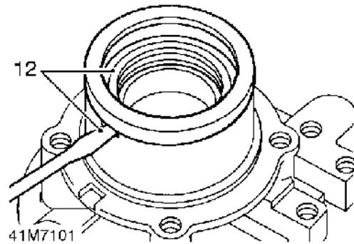
12. A l'aide d'un tournevis inséré dans la fente du boîtier de sortie arrière, extraire le pare-boue du boîtier.
