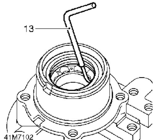
13. En prenant soin de ne pas endommager le boîtier de sortie arrière, déposer le joint d'huile d'arbre de sortie et le jeter.
