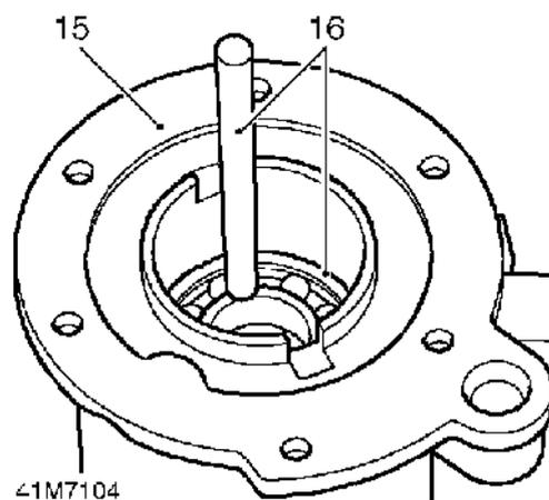
15. Soutenir le boîtier de sortie arrière sur des blocs de bois appropriés.
