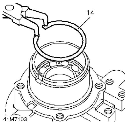
14. A l'aide d'une pince à circlips appropriée, enlever le circlip maintenant le roulement d'arbre de sortie et le jeter.
