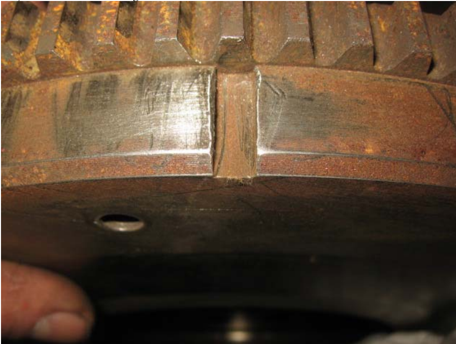
258) Mise en place du volant moteur, de la plaque de renfort, c'est une grosse rondelle unique pour les huit vis de maintien du volant. Chaque vis est enduite de Loctite oléo étanche rouge car juste derrière il y a notre huile prisonnière à vie qui bien sûr cherche à s'évader par tous les moyens, bon OK on sait tous, que les prisons anglaises ne sont pas trop bien gardées.
