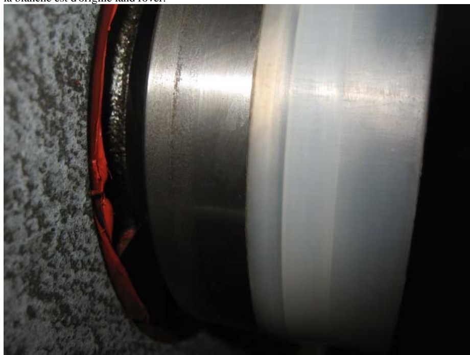
252) Un autre modèle de bague de protection vendu avec le joint spi dans les grandes pochettes de joints celles qui ont le carton rayé blanc et vert (Payen)
