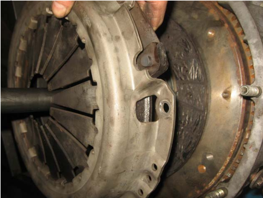
272) Il y a dans le mécanisme 3 trous de centrage à 120° et sur le volant 3 tétons, ben faut juste que les uns tombent en face des autres 😊
