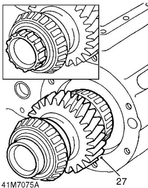
27. Déposer le pignon d'entrée de l'arbre secondaire et les roulements à rouleaux coniques.
