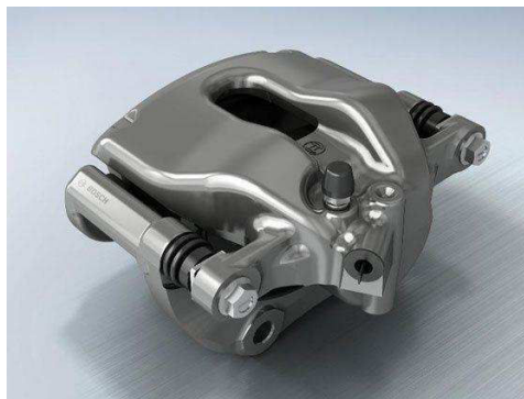
FIGURE 2.1 – Étrier du système de freinage ZoHe59 utilisé pour les essais
