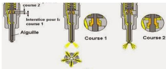
**Attention:** ces injecteurs ne sont pas réparables ! Seul le contrôle de la pression d'ouverture, et le contrôle de l'étanchéité sont possibles. De plus, si pour des raisons diverses, ces injecteurs doivent rester déposés pendant quelque temps, il est vivement conseillé de les immerger dans un récipient contenant du gasoil propre.
