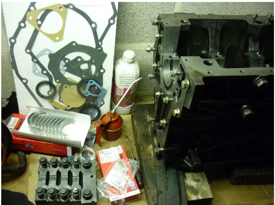
Prêt pour mise en place des coussinets et remontage du vilebrequin:
