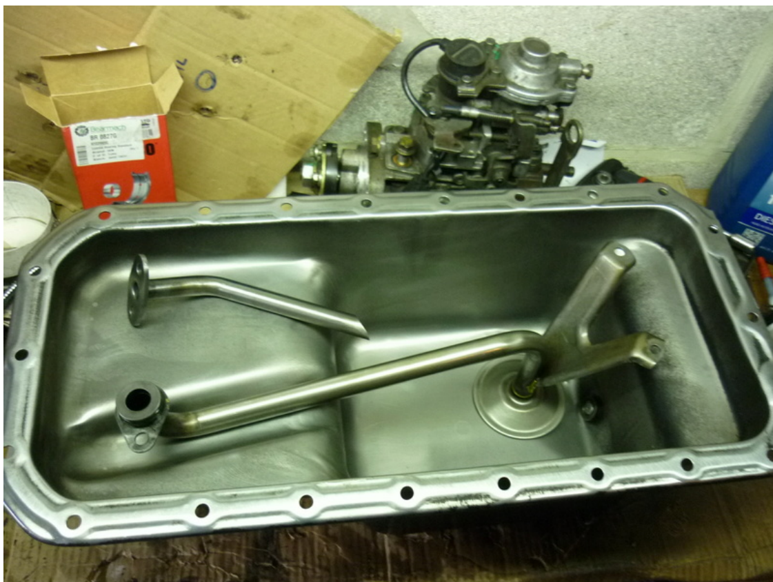
Changement du joint torique de tuyau de crépine:
