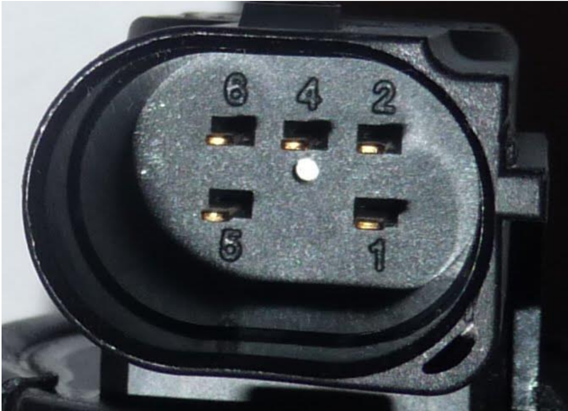
Seules les broches 1 et 5 sont connectées au moteur.
